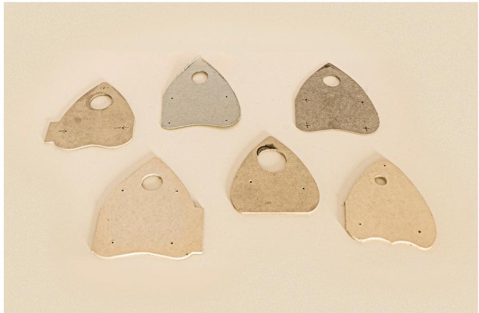
↑ [Fig. 60] Planchetas de MDF resultado del corte con CNC.
