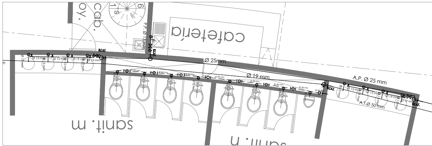
① PLANTA DE DETALLE INSTALACIÓN HIDRÁULICA EN SANITARIOS DE AUDITORIO ESC. 1:75
