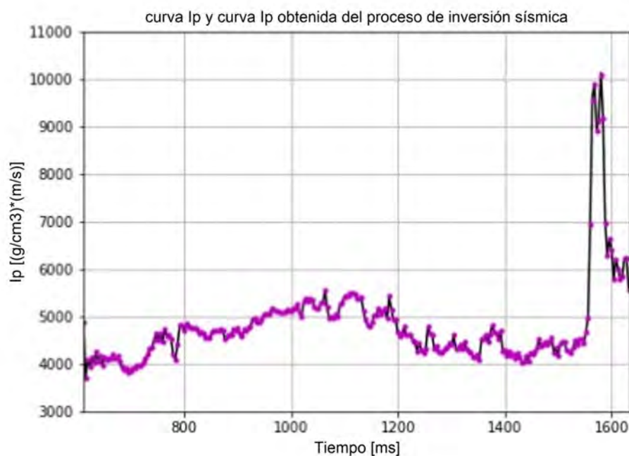
Figura 5.42: Superposición y comparativa de curvas de impedancia en el pozo de validación. (línea negra) Curva de registro de impedancia del pozo. (puntos color magenta) Curva de impedancia calculada mediante el algoritmo de inversión.
