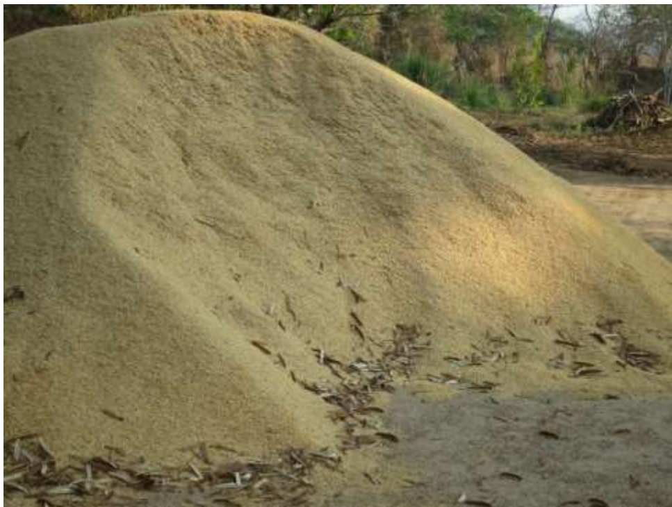
Figura 128. Cascarilla de café utilizada como desgrasante de tabiques y tejas introducida recientemente
