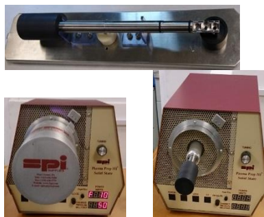
Figura 9. Portaobjetos y generador de plasma para modificaciones de superficies.
