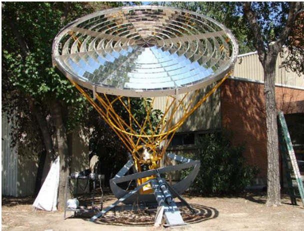
Figura 21. Fotografía del concentrador solar empleado por Llorente et al y esquema que ilustra la concentración solar en el dispositivo.
