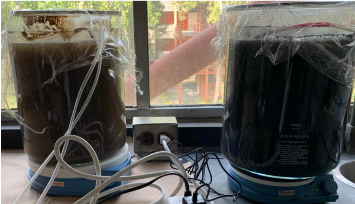
Figura 6. Montaje de los biorreactores. A la izquierda se observa el MBBR de aclimatación doméstica y a la derecha el MBBR textil.
