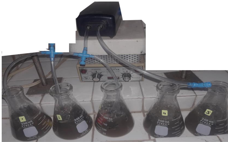
Figura 5. Imagen del montaje experimental para la rampa de aclimatación. Cada matraz fue colocado como un biorreactor de lodos activados con 180 ml de volumen de trabajo, bajo un esquema discontinuo secuencial.
