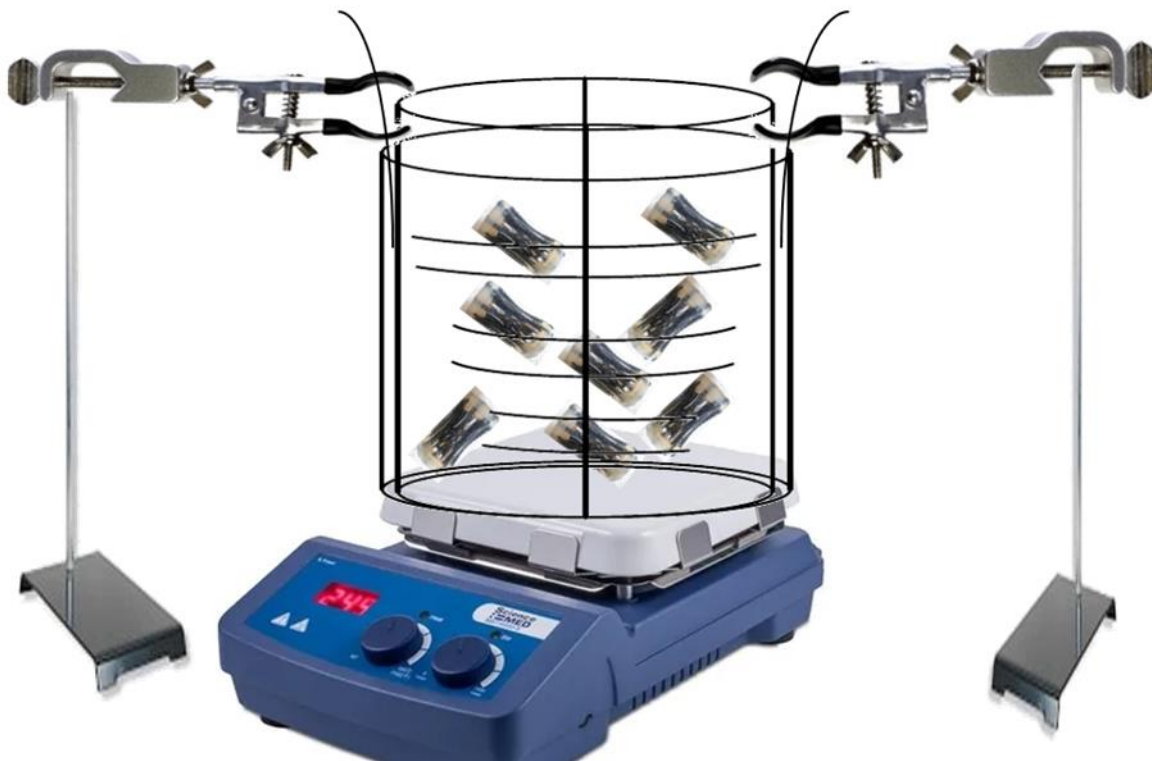
Figura 8. Diseño del MBBR utilizado en la comparación de estrategias de colonización.
