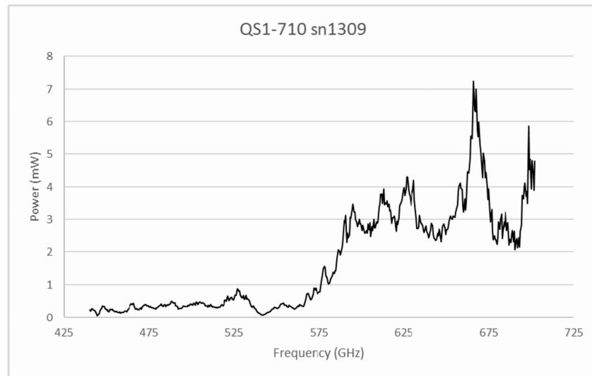
Figura 4.1: Gráfica de la potencia emitida por el BWO QS1-710 Microtech Instruments Inc. en función de la frecuencia.
