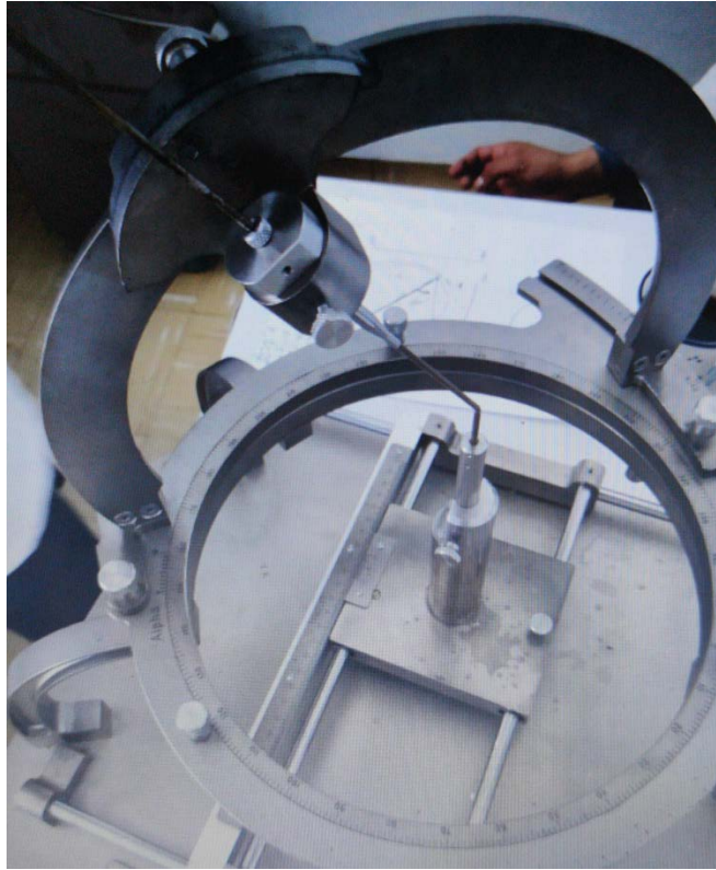
Figura 4 El sistema estereotáctico Brown-Roberts-Wells demostrando comprobación de valores obtenidos con el fantasma base
