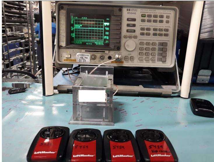
Figura 3.10: Fotografía de un lote de transmisores antes de ser probados en la línea de producción.
