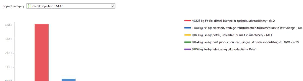
Figura A.11: Potencial de agotamiento de metales. Contribución de los materiales utilizados, calculado en el software OpenLCA
