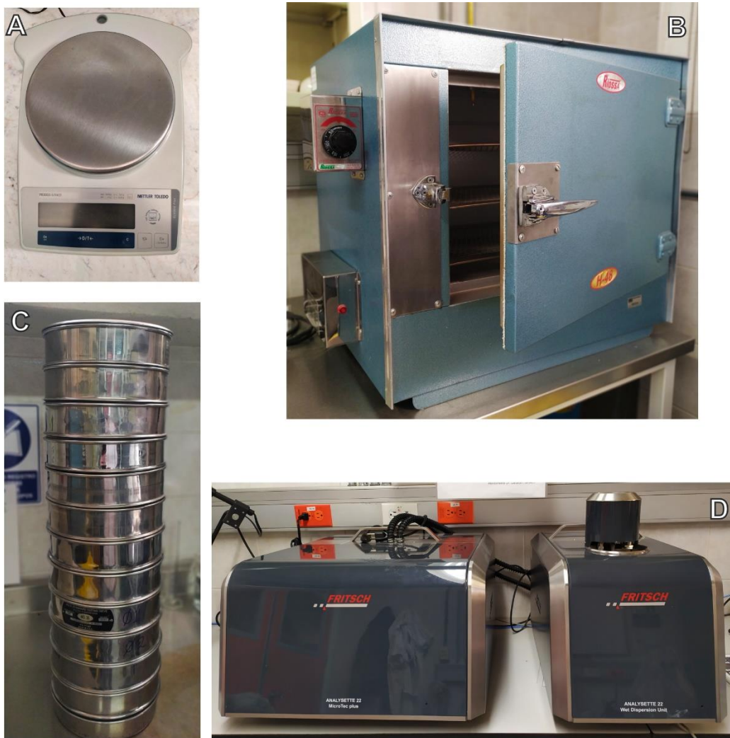
Figura 23. Equipos del laboratorio de Vulcanología Física utilizados en el análisis granulométrico.
