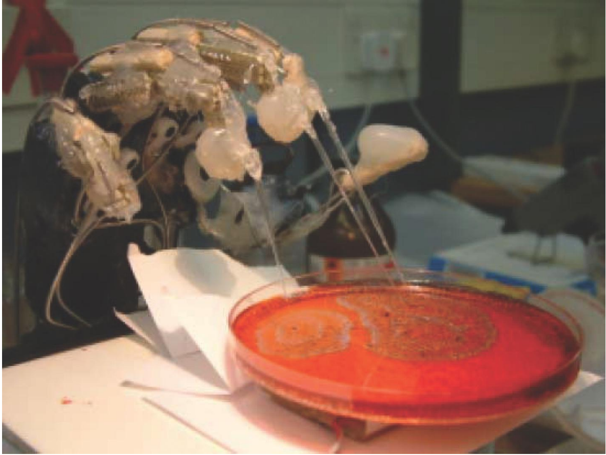
Fig. 26 Mano robótica controlada por el oscilador Belousov-Zhabotinsky.
