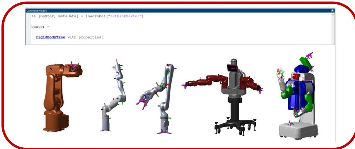
**Ilustración 22.** *Interfaz de Matlab con Robotics System Toolbox, Recuperado en: <https://es.mathworks.com/products/robotics.html>*
