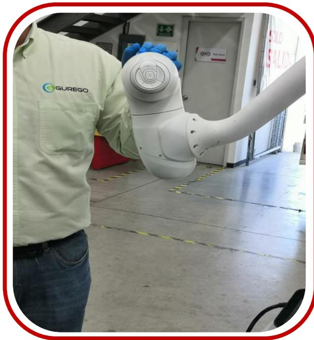
**Ilustración 4.** Eslabón final del robot y sus botones
