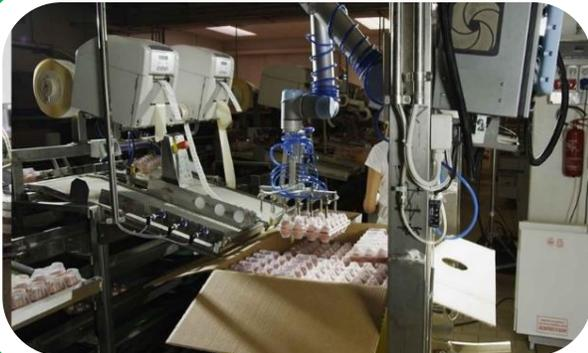
*Ilustración 8. Industria Cascina, Italia, Robots de UR utilizados para el empaquetado de huevos, Recuperado de <https://www.universal-robots.com>*
