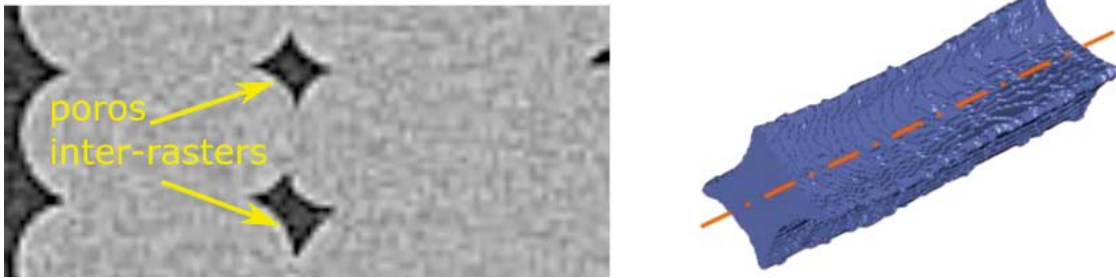
Figura 3.7: Imagen CT de la mesoestructura del proceso EM unidireccional y reconstrucción de poro inter- raster [60]
