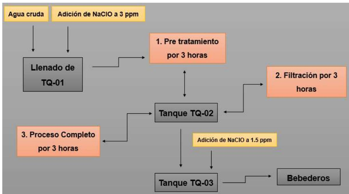
Figura 15. Diagrama simplificado del proceso de purificación de Campus I.
