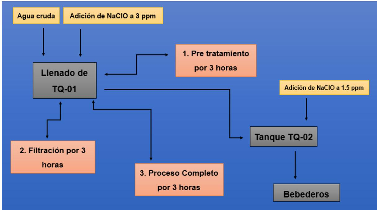
Figura 16. Diagrama simplificado del proceso de purificación de Campus II.
