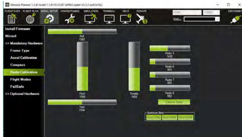
Figura 3.14: Sección del Mission Planner, para calibrar la emisora RC
