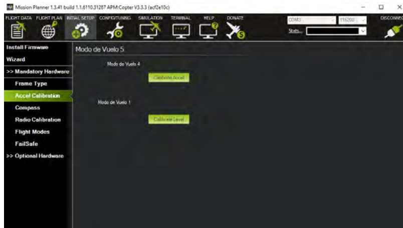
Figura 3.16: Sección del Mission Planner, para calibrar los ejes del UAV
