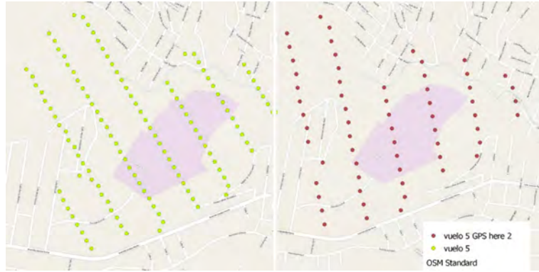
Figura 4.10: Comparación entre dos vuelos en la misma zona, del lado izquierdo se muestra los centros de proyección con el módulo de la brújula dañado, en las primeras líneas se alcanza a apreciar que el recorrido tiene una forma de zigzag, del lado derecho los centros de proyección de las imágenes con el nuevo módulo de brújula, donde se aprecia un recorrido uniforme.
