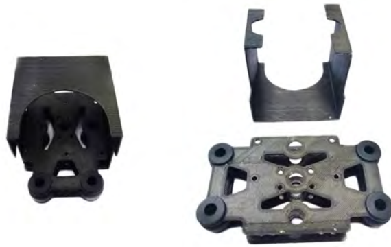
Figura 4.4: Base de la cámara impresa en 3D con amortiguadores de plástico suave
