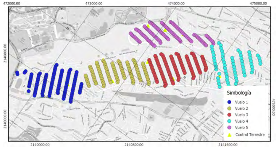
Figura 4.9: Centro de proyecciones de las imágenes capturadas por los diferentes vuelos realizados, (sistema de referencia WGS84 UTM zona 14)
