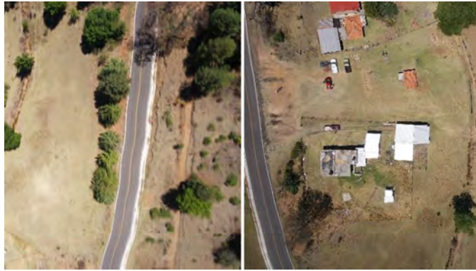
Figura 4.2: Imágenes captada en el primer vuelo fotogramétrico del prototipo, donde se aprecia ondulaciones en las imágenes.
