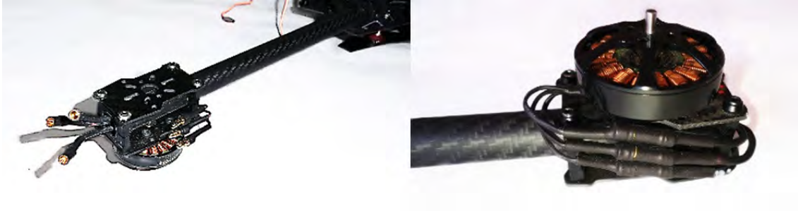
Figura 3.6: Conexión de los motores con los ESC
