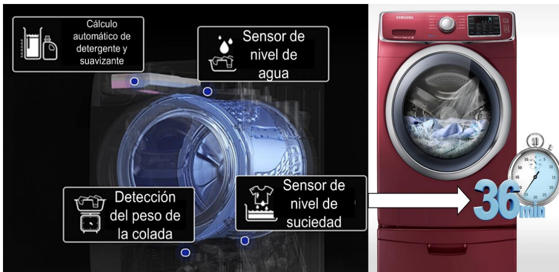
Figura II. 3. Lógica difusa aplicada en lavadoras
