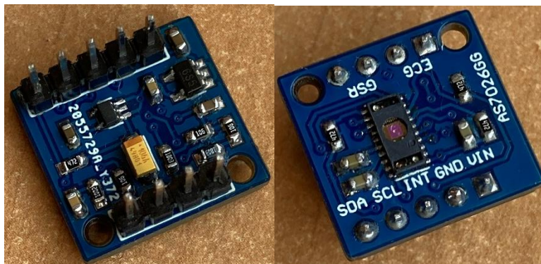
Figura 64. PCB del sensor biométrico AS7026GG
