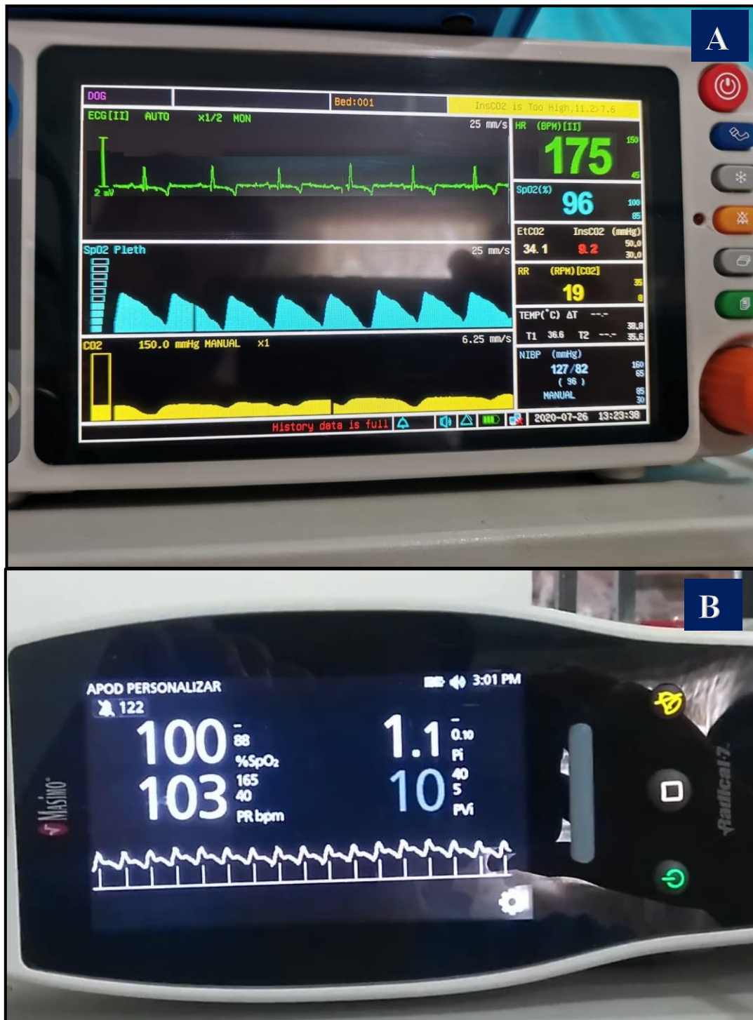
Figura 29. A ) Monitor de signos vitales modelo VS2000VC (Utech Medical Device, China) durante el proceso perioperatorio. B ) Monitor de oximetría y co-oxímetro, Radical 7 (Masimo, EUA).
