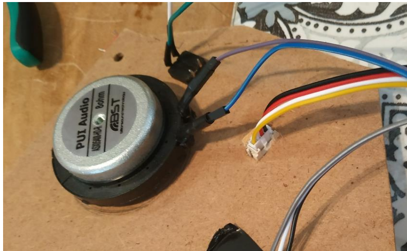
Ilustración 40 Transductor vibratorio montado
