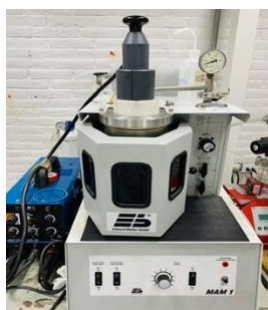
Fig.3.1. Horno de arco eléctrico
