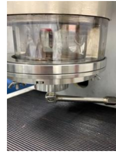
Fig.3.7. Acople del sistema de colada por succión
