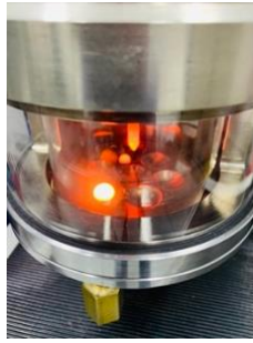
Fig.3.3. Obtención de lingote maestro
