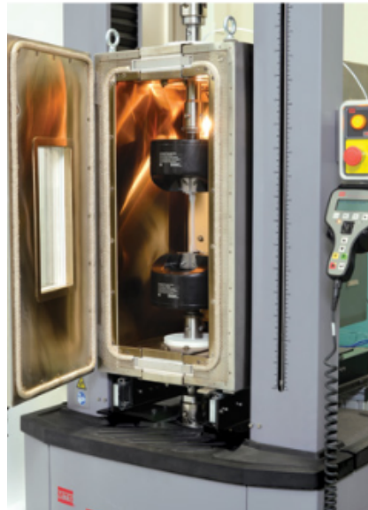
Figura 1.15: MTS Máquina de tracción uniaxial con datos controlados [13].
