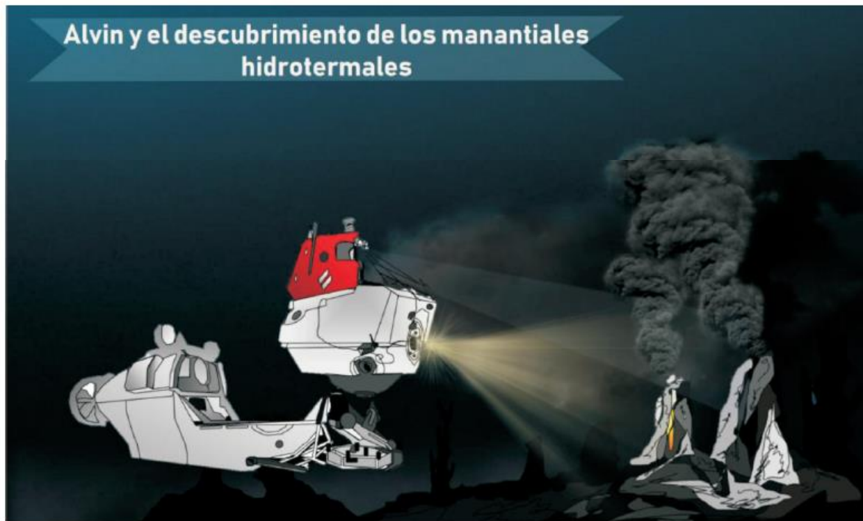
Figura 1. El sumergible Alvin es un submarino tripulado que permite la recolección de datos en el fondo oceánico. Su alcance es de hasta 4500 metros de profundidad en inmersiones que pueden durar hasta 10 horas. Este sumergible es propiedad de la Marina de los Estados Unidos, fue puesto en servicio el 5 de junio de 1964 y es operado por la Institución Oceanográfica Woods Hole.
