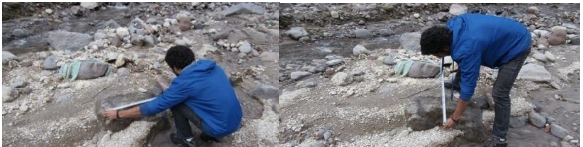
Fig 3.2. Obtención de la medida de los clastos en campo. A) Medida del eje mayor. B) Medida en el eje menor. Imágenes capturadas durante la primera campaña realizada el 18 marzo del 2018.
