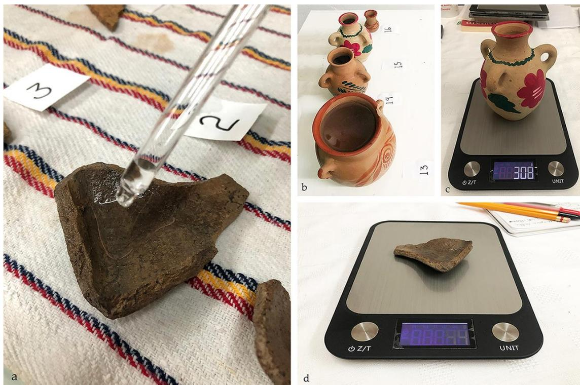
FIGURA 6.4. Metodología en la Prueba de Porcentaje de Porosidad Aparente por absorción de agua. **a.** Saturación por goteo constante en la parte interior de un tiesto Granular. **b.** Vasijas etnográficas utilizadas como referencia. **c.** y **d.** Vasija etnográfica saturada y tiesto arqueológico saturado en el proceso de pesaje.
