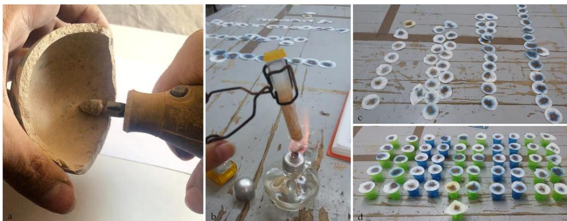
FIGURA 6.7. Raspado y proceso del análisis químico de las muestras de cerámica Granular. (Fotos b-d cortesía de Meztli Hernández).
