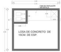
PLANTA LOSA TAPA DE CISTERNA ESC: 1/20
