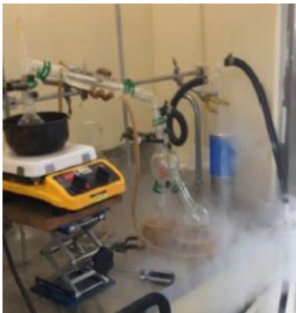
Ilustración 7. Destilación a presión reducida (Audifred, 2019)
