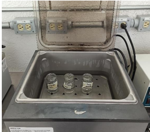
Ilustración 13. Sistema de calentamiento a temperatura constante.
