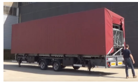
Fig.5.14. Sistema Mobil seatsd-Gradas plegadas
