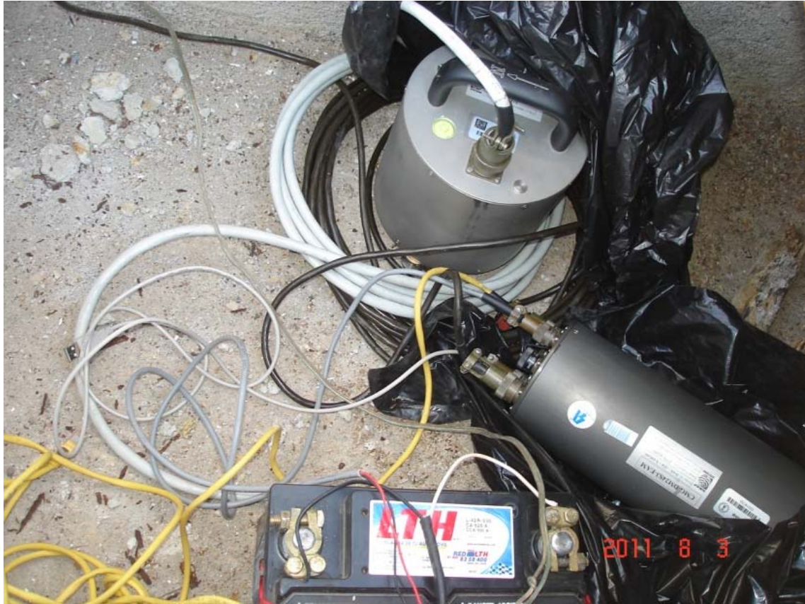
Figura 2.2.1 Estación TV01 que consta de un sismómetro Guralp modelo CMG-DM24X de banda ancha, su batería y un registrador de mayor capacidad (16GB). Fuente: Tomado de Lermo et al., (2011).
