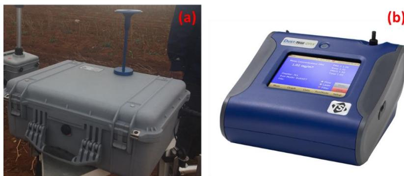
**Figura 2.14.** (a) Sistema del monitor portable de aerosol DustTrak, y (b) DustTrak 8533 (TSI, 2004).
