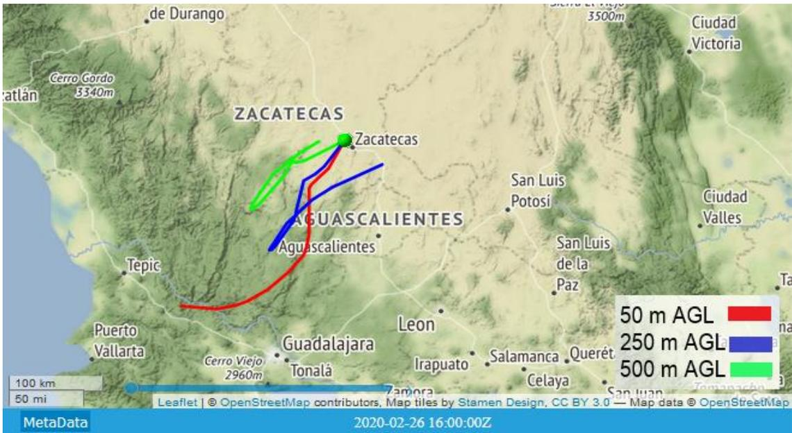
**Figura H.3.** Trayectoria de avance de las masas de aire a 50 m, 250 m, y 500 m sobre el nivel del suelo para el 26 de febrero de 2020 (Campaña de muestreo en Zacatecas).
