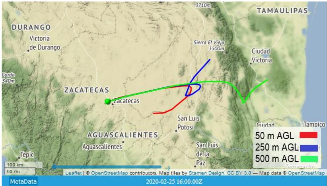
**Figura H.2.** Trayectoria de avance de las masas de aire a 50 m, 250 m, y 500 m sobre el nivel del suelo para el 25 de febrero de 2020 (Campaña de muestreo Zacatecas).
