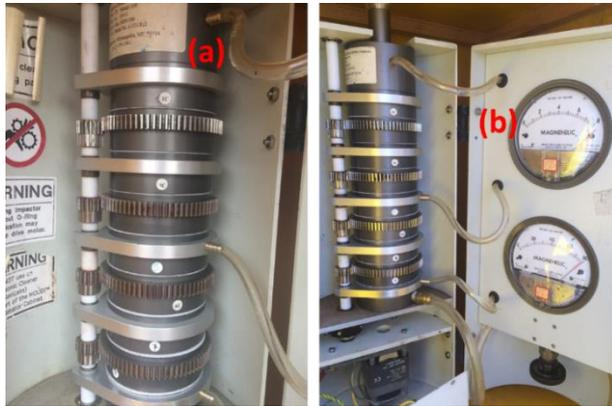
**Figura 2.10.** Partes del MOUDI: (a) impactador en cascada y (b) rotador.
