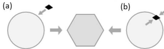
**Figura 1.8.** Esquema de la nucleación por contacto: (a) nucleación por contacto de "afuera hacia adentro" y, (b) nucleación por contacto "de adentro hacia afuera". Tomada de Durant & Shaw (2005).
