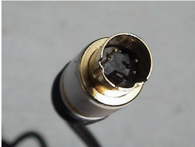
Figura 4. Conector minidin para Video-S. Wikipedia (s. f.-a).
