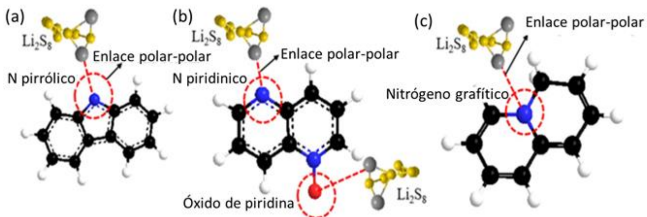
Figura 2.8 Formas en las que el N puede dopar en los CNT y el grafeno: (a) N pirrólico, (b) N piridinico y (c) N grafitico.
