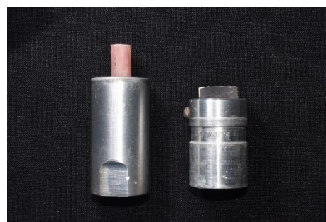
Fig. 19 Sujetadores para muestras de materiales dentales e identadores abrasivos (Fuente directa)
