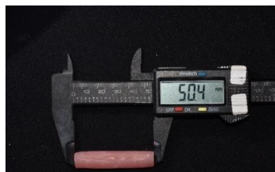
Fig. 23. Los indentadores tuvieron una longitud promedio de 50 mm por un diámetro de 8 mm (Fuente directa)
