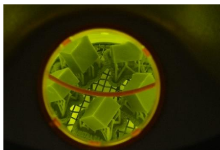
Fig. 9 Ciclo de fotopolimerizado de 15 minutos (Fuente directa).
