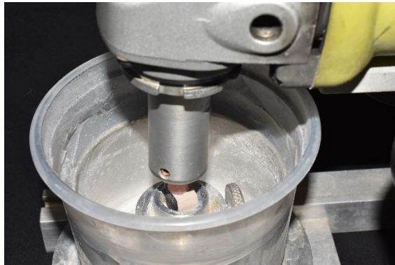
Fig. 21 recipiente de acero inoxidable con aditamento de plástico externo, lo cual permite mayor control en la temperatura (Fuente directa)
