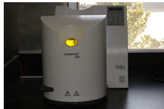
Fig. 8 Horno de fotopolimerizado Lumamat 100 (Fuente directa).
