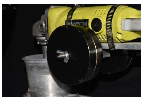
Fig. 20 Discos de 1 Kg de peso (4 kg en total) utilizados para lograr mayor estabilidad (Fuente directa)
