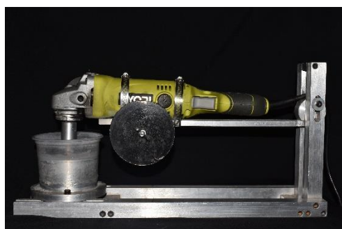
Fig. 18 Sistema de abrasión utilizando pulidora Ryobi (Fuente directa)
