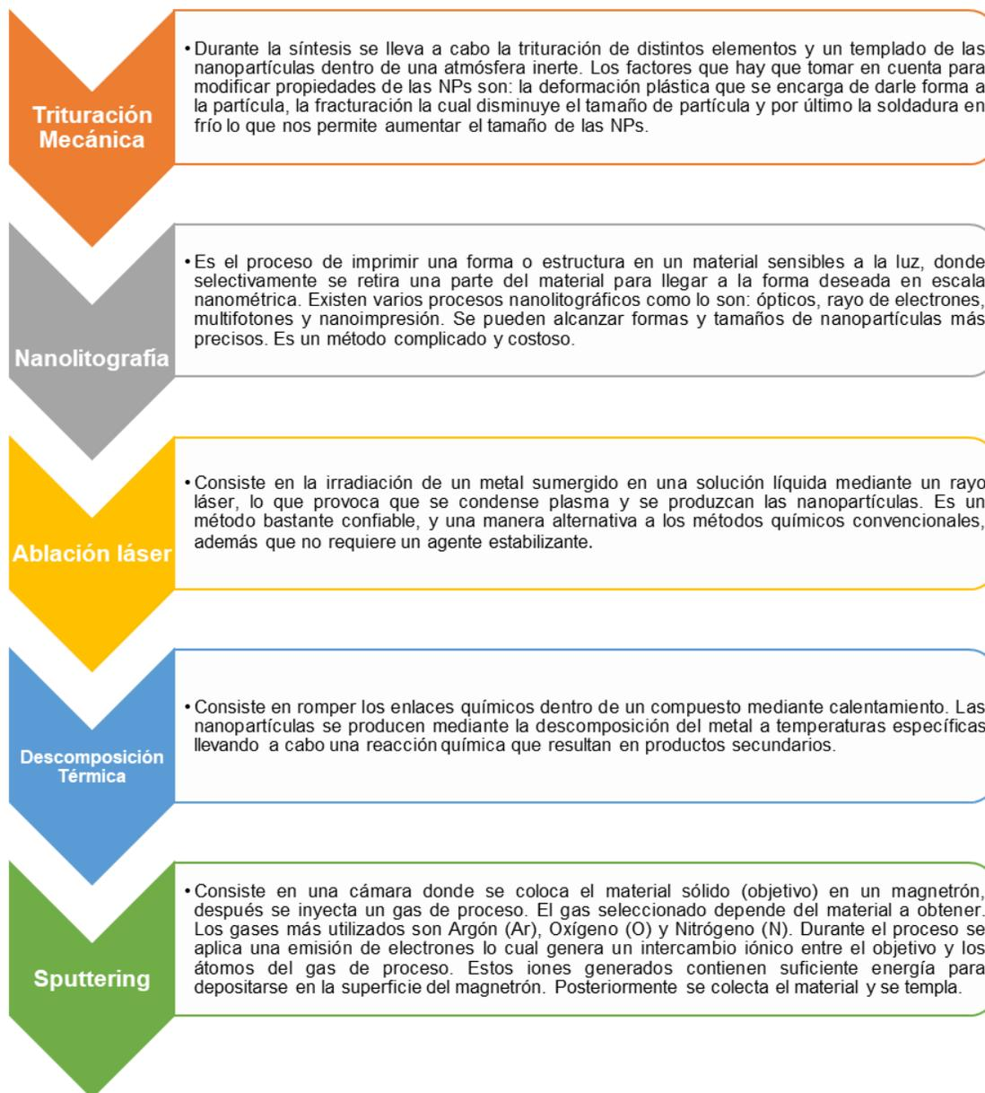
**Figura 3.4** Métodos “Top Down” síntesis de nanopartículas
