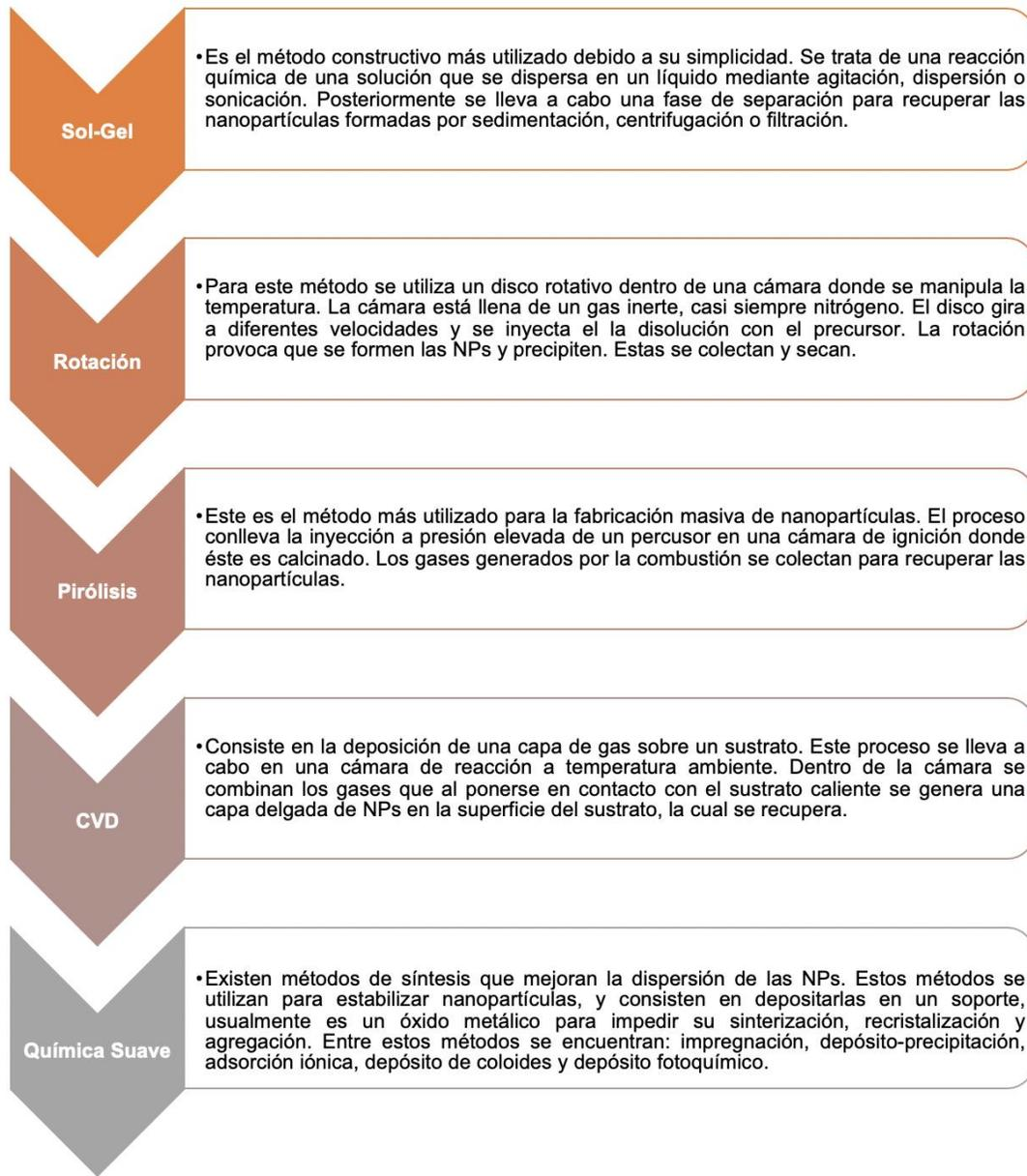
**Figura 3.5** Métodos de síntesis de nanopartículas “Bottom Up”
