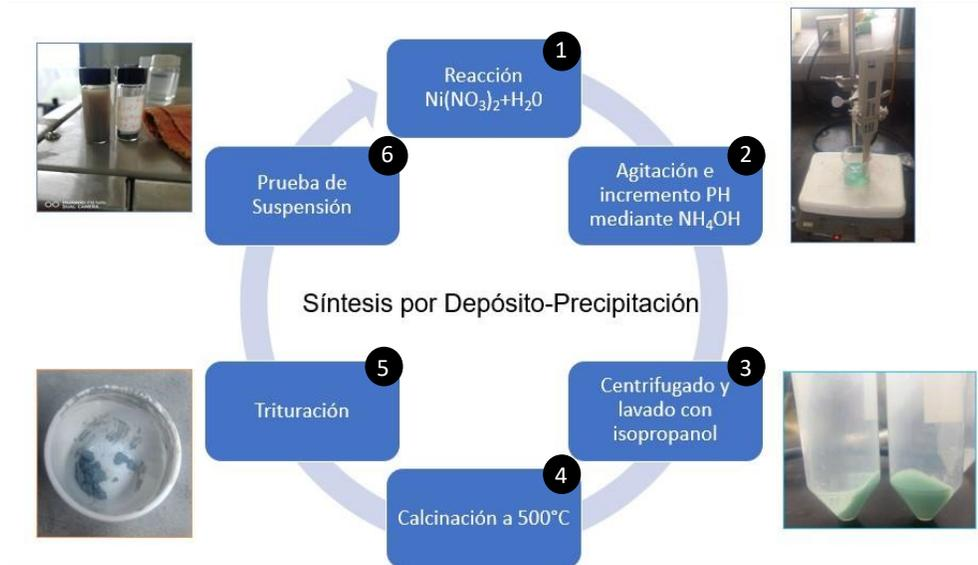
**Figura 5.1** Proceso de Síntesis por depósito-precipitación de nanopartícula LIRF-1. Esta síntesis se ha escalado hasta 3.5 g, manteniendo la siguiente relación: por cada gramo de nitrato de níquel se requieren 60 mL de agua destilada.
