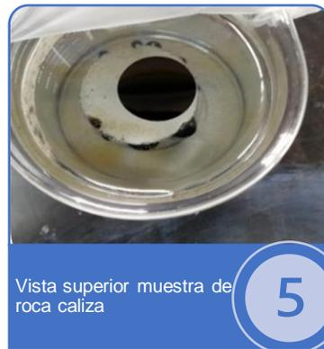
**Figura 5.11** Procedimiento de pruebas de imbibición espontánea
