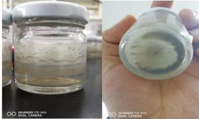
**Figura 5.20** Emulsión  $MgCl_2$  @50,000ppm,  $NiO$  @2500ppm, Drakeol- gotas de tamaño muy fino, buena estabilidad. A la derecha, misma emulsión vista desde abajo, se percibe demasiado material precipitado
