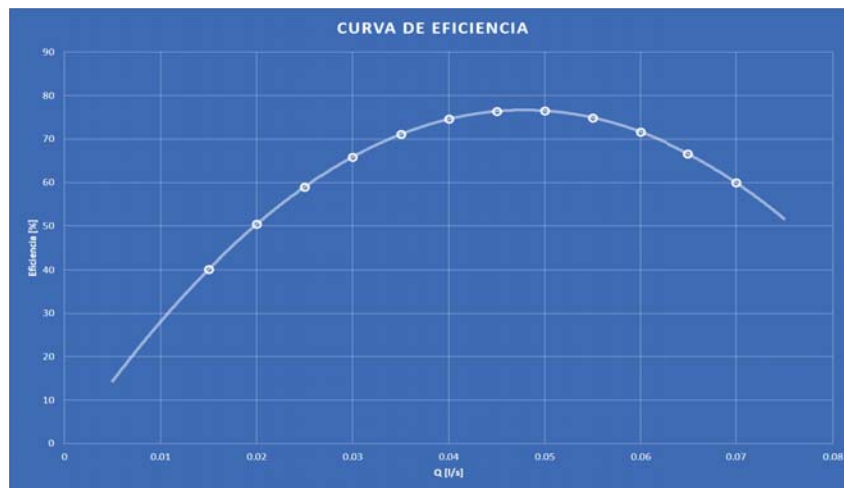
Fig. 5.5 Curva de eficiencia de la bomba actual
