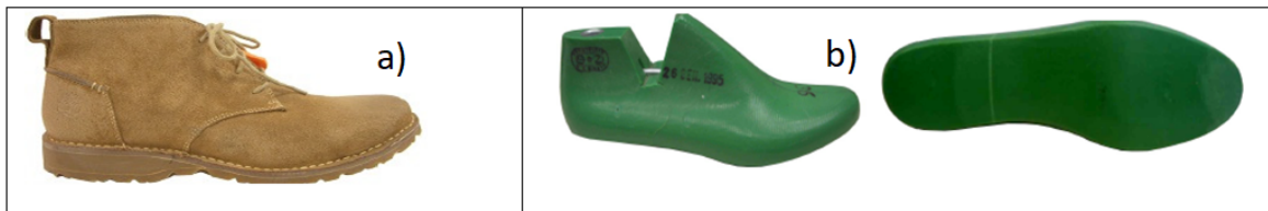
Ilustración 29. Calzado y horma para fabricación tipo Stich Down & S. Crispino
