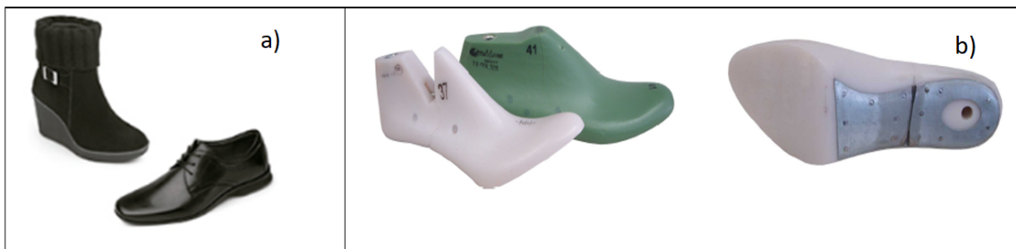
Ilustración 27. Calzado y horma para fabricación tipo cementado
