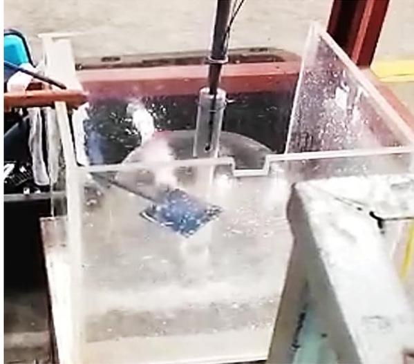
*Figura 4.30. Proceso de enfriamiento durante el ensayo Jominy de la aleación 6061.*
