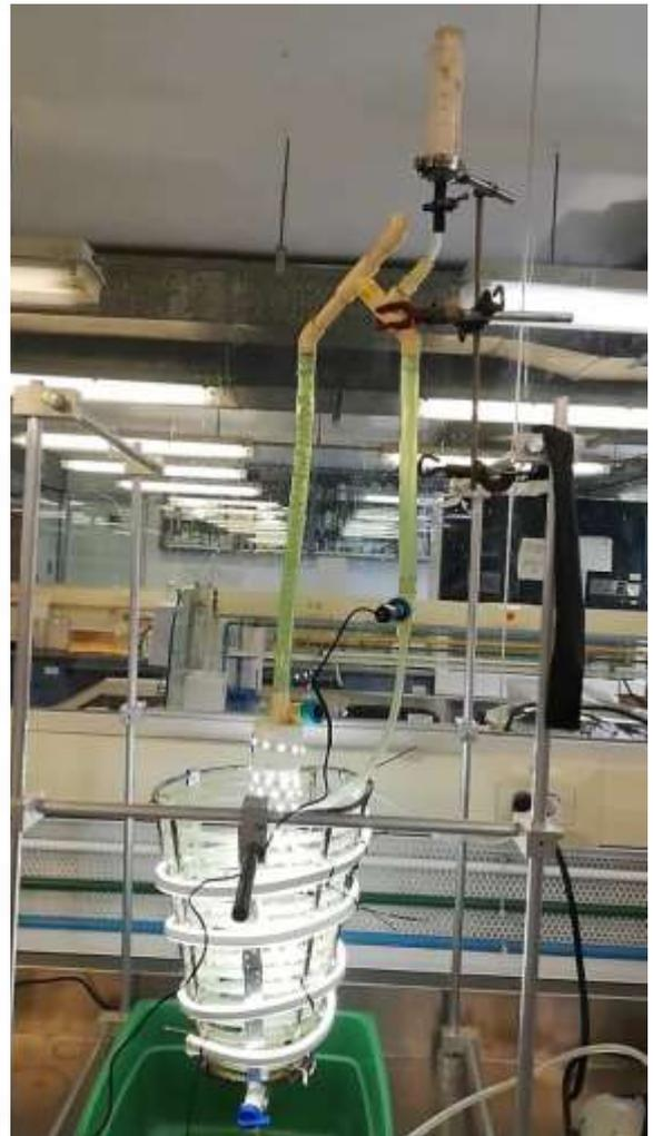
Figura 10.1. 1 Fotobiorreactor en funcionamiento con microalgas
