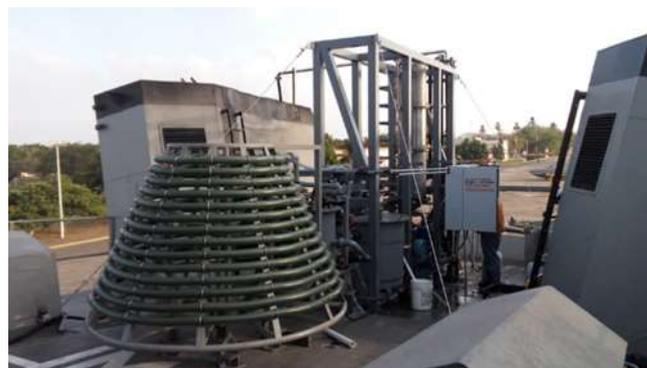
*Figura 4. 3 Fotobiorreactor tipo helicoidal*
