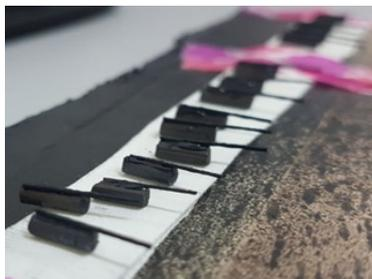
*Electrodo monopolar de carbono formado por dos fibras con diámetros de 2 mm y 0.25 mm y recubierto con PlastiDip y cemento dental (Gallino y cols., 2019).*
