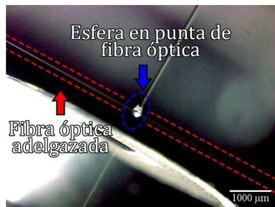
Figura 3.9: Vista superior de un acoplamiento entre una fibra adelgazada de  $1 \mu m$  de diámetro y una microesfera de  $250 \mu m$  de diámetro
