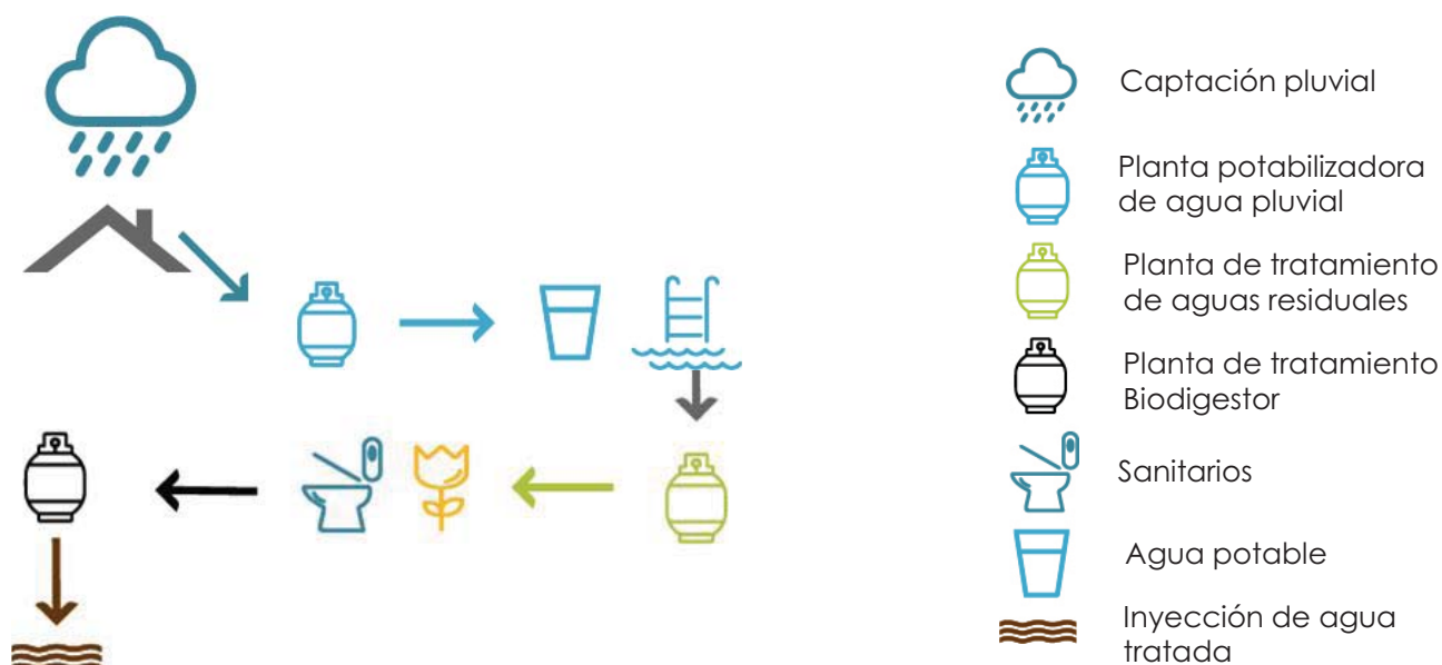
[Gráfico IV.12] Diagrama de aprovechamiento pluvial
