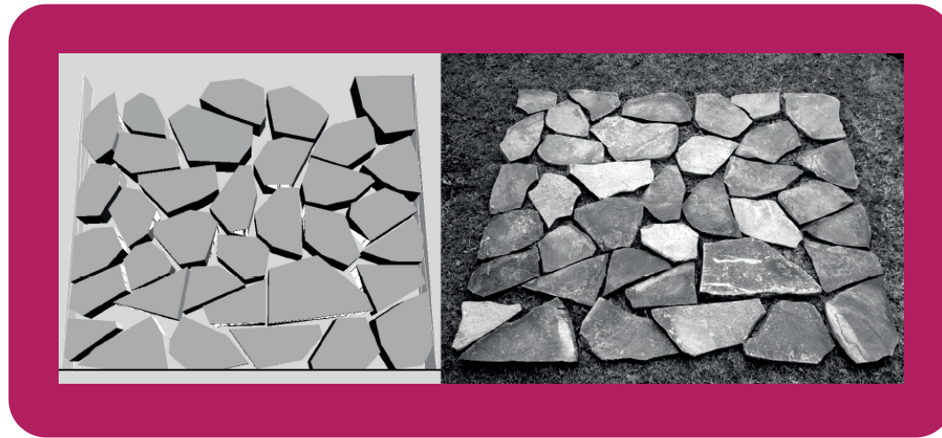
Figura 4.31: Ilustra una estructura virtual hecha en CAMDAC y su construcción en el mundo real.
