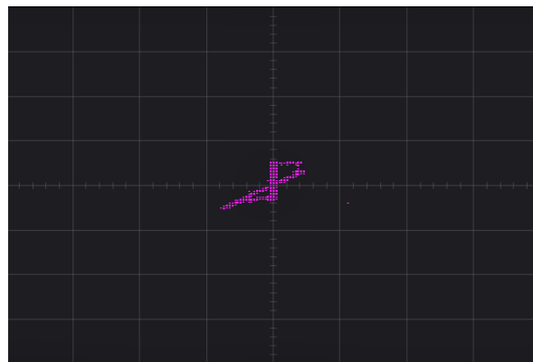
Figura 5.18. Registro experimental de lazo cruzado del TBM para 0.4 Hz.
