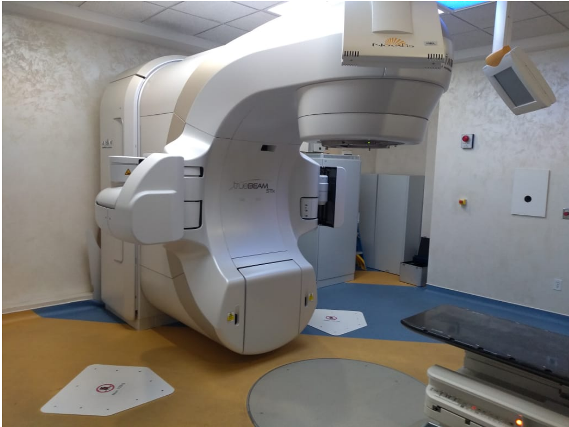
Figura 2.1: Acelerador TrueBeam STx
