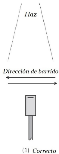
Figura 2.2: Orientación del Diodo, TRS 483
