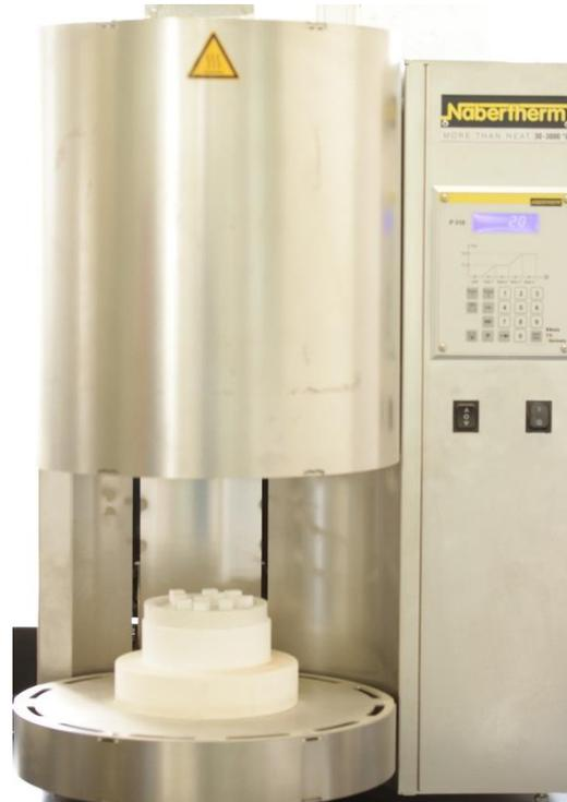
Figura 5 Sinterización muestras de Zr.
