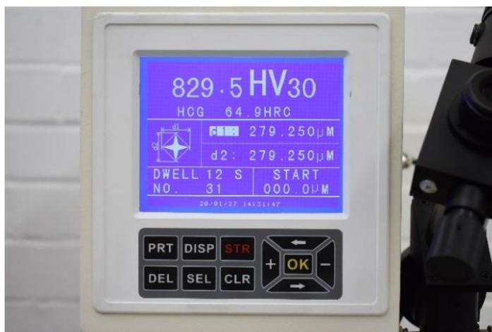
Figura 10 Pantalla digital del durómetro Matsuzawa MHT2.
