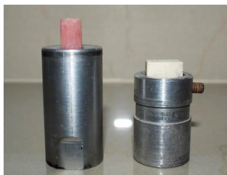
Figura 23 sujetadores con indentador y muestra, respectivamente.
