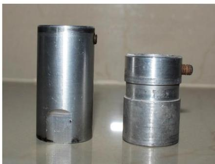
Figura 22 Sujetador de indentador abrasivo y sujetador de muestra (izquierda a derecha).
