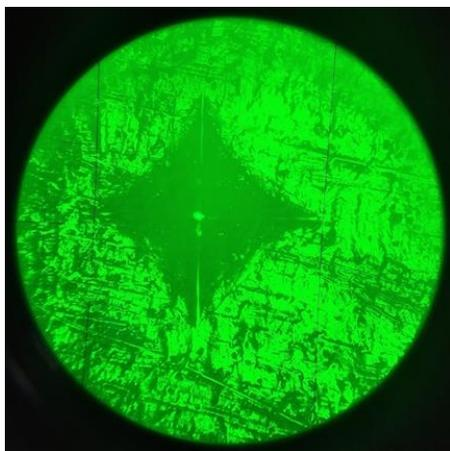
*Figura 37 Huella en el polímero D, se aprecian los ejes tomando la longitud en D1.*
