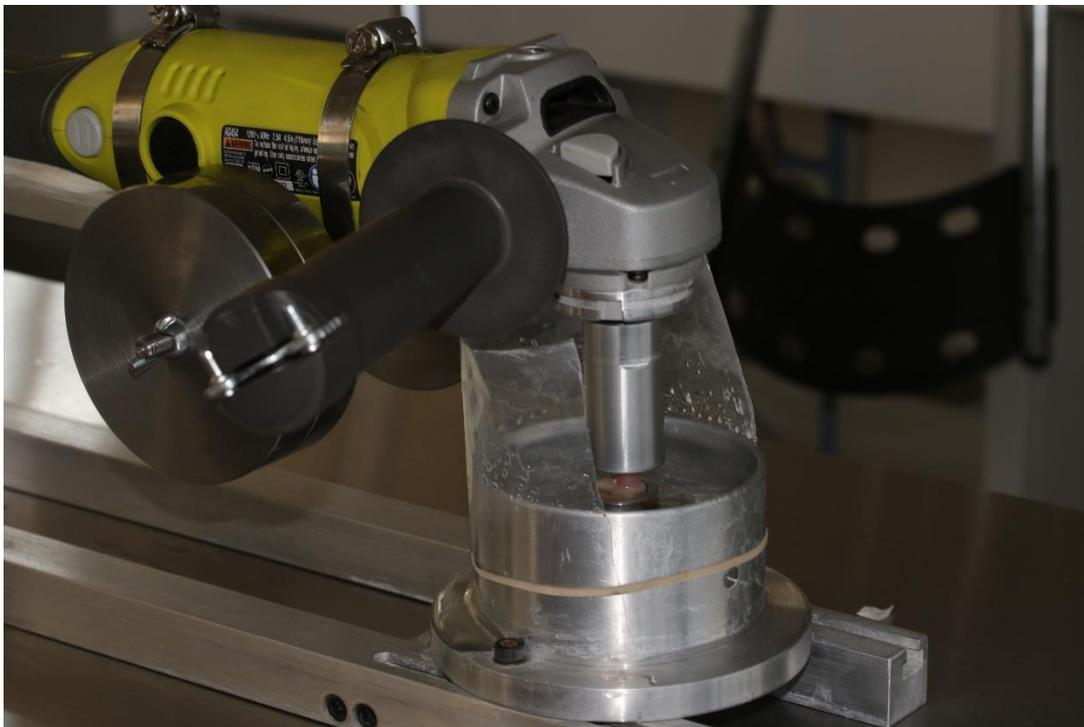
Figura 21 Sistema de abrasión en funcionamiento.
