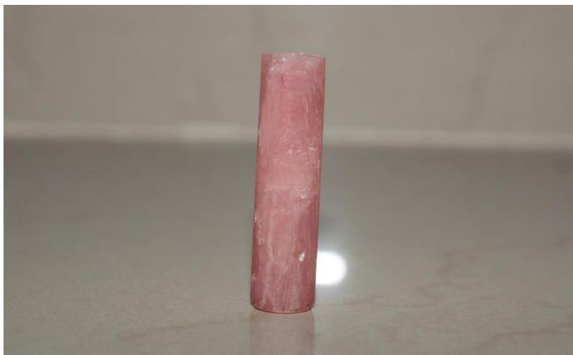
Figura 9. Indentador abrasivo de acrílico termocurado.
