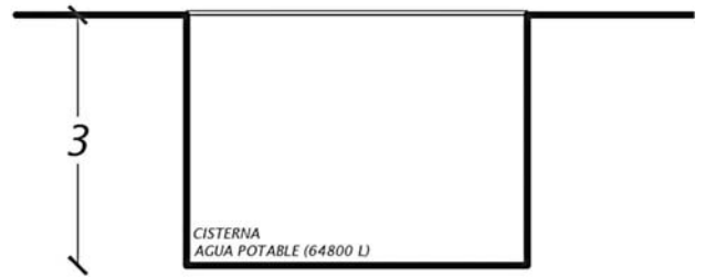
Corte de la Cisterna de agua potable. [Imagen 255]. Recuperado de: Creación propia
