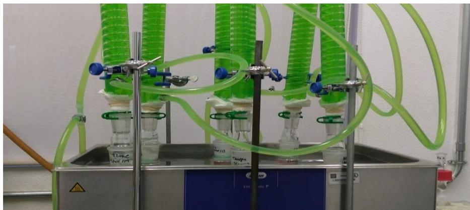
Figura 13. Extracción de muestras de organoclorados utilizando la celda de extracción asistida por ultrasonido.
