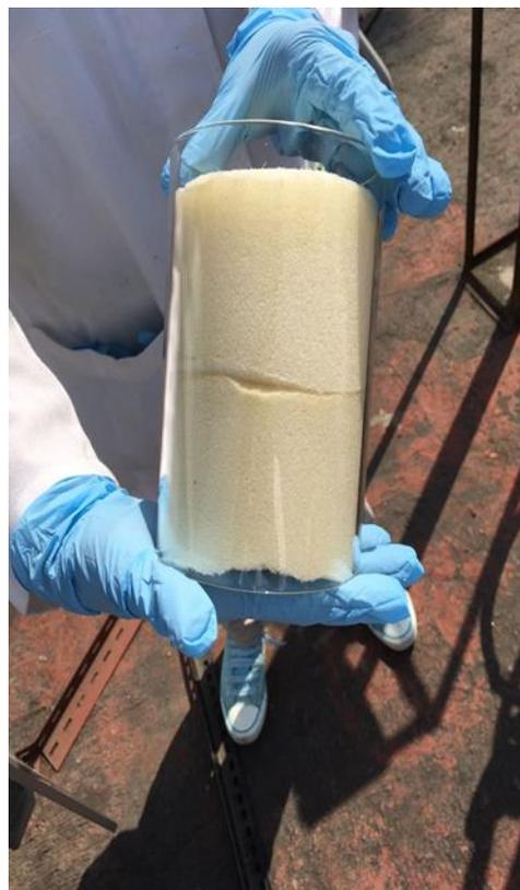
Figura 10. EPU para coleccionar la fase gas
