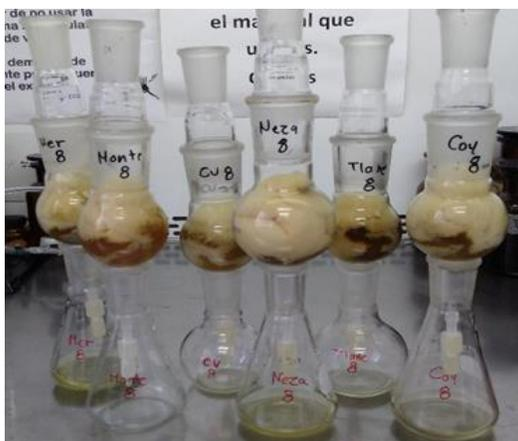
Figura 14. EPU después de la extracción
