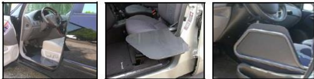
Fig. 4. Superficie de transferencia instalada en un automóvil. [18]
