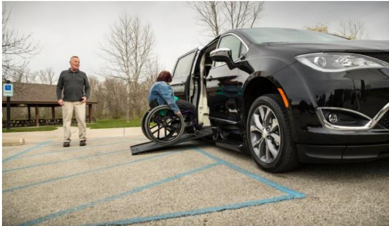
Fig. 11. Camioneta modificada con rampa de acceso. [19]
