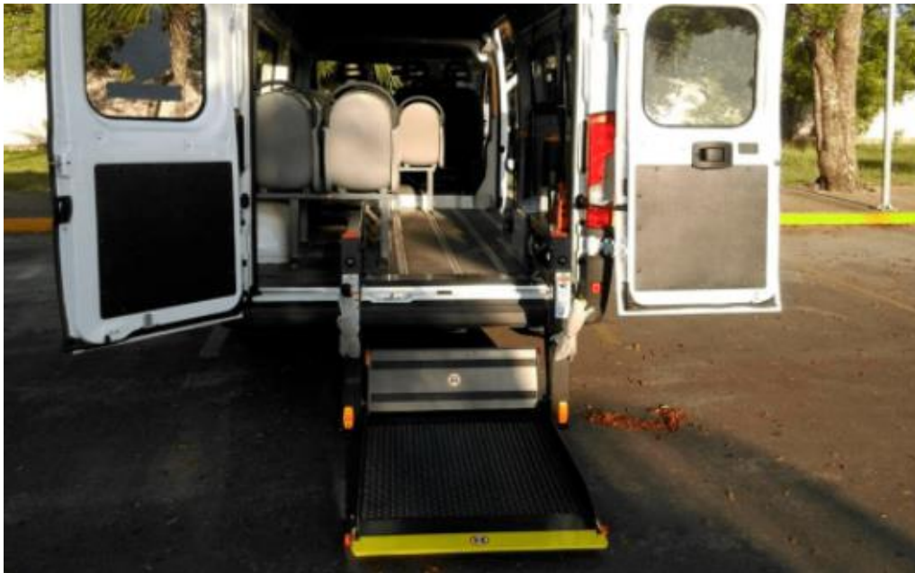
Fig. 12. Van estándar con plataforma fija. [19]
