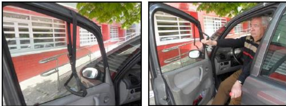
Fig. 1. Cinta colocada en marco de la puerta del piloto. [18]
