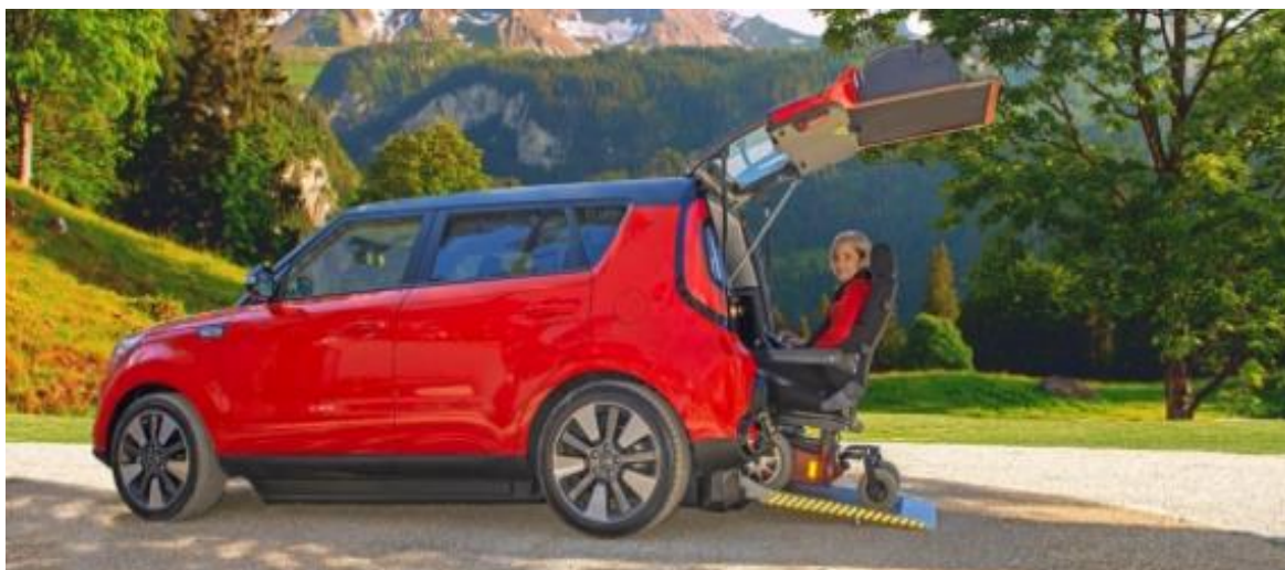
Fig. 13. KIA SOUL modificada con rampa eléctrica incorporada al vehículo.
