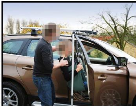
Fig. 10. El elevador portátil de personas operando. [18]
