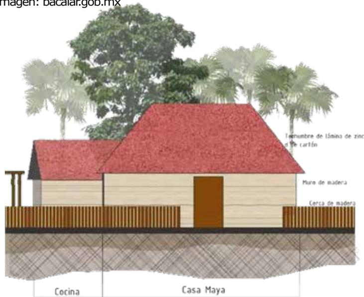
Vivienda, cubierta de lámina de zinc o cartón, muros de madera y cerca de madera.
